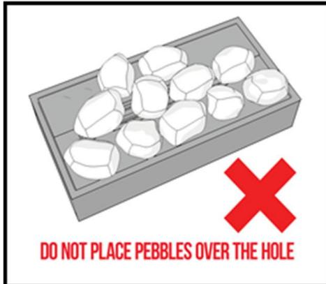
Die dekorativen Kieselsteine oder andere ähnliche Produkte sollten niemals so verwendet werden, dass die Öffnung des Brenners abgedeckt wird.
